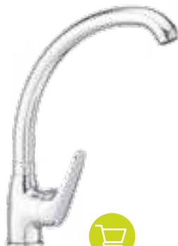
SERIE FIGUS 144315 Cuerpo de latón, Maneta Metálica, Cartucho Ø 40 mm, aireador M24, caño giratorio, y tuerca de fácil fijación, Latiguillos 40 cm, marca Flexitub, con certificado AENOR, . Alto 28,5 cm. certificación Sanitaria ACS. 29'95
