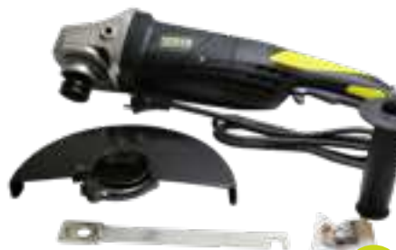
AMOLADORA PROFESIONAL 121578 Potencia nominal 2000W. Velocidad sin carga 6500 rpm. Diámetro del disco de amolar 230 mm. Rosca del eje de la amoladora M14. 54'95
