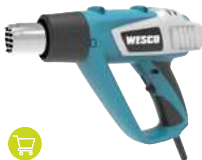
DECAPADOR 2000W 144640 Protección contra sobrecalentamiento. Empuñadura de goma sobremoldeada. Interruptor de 3 posiciones (40°C 300 l/min 350°C 300 l/min 550°C 500 l/min) Función de aire frío (40°C 300 l/min) Potencia nominal: 2000 W Flujo de aire de 3 posiciones 40° 300L/minuto 350° 300L/minuto 550° 500L/minuto Peso: 0,6 kg 1 boquilla de concentración. 1 boquilla plana. 1 boquilla de protección de vidrio. 1 boquilla de gancho. 1 raspador. 24'95
